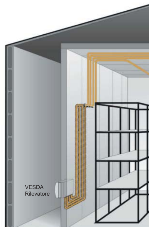
Figura 3. Il rilevatore VESDA montato esternamente all'area protetta
